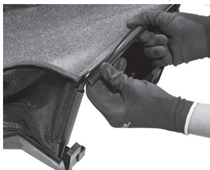
Figura 7 – Encaixe as canaletas
