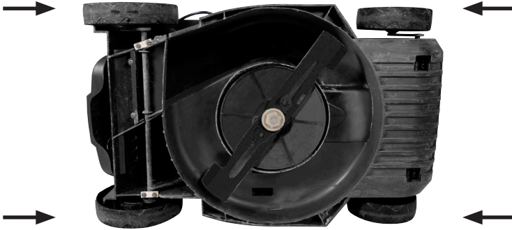
Figura 14 – Ajuste de altura de corte
